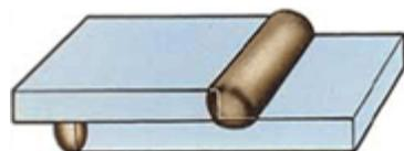
**Тавровое** сварное соединение, в котором торец одного элемента примыкает под углом и приварен к боковой поверхности другого элемента.
